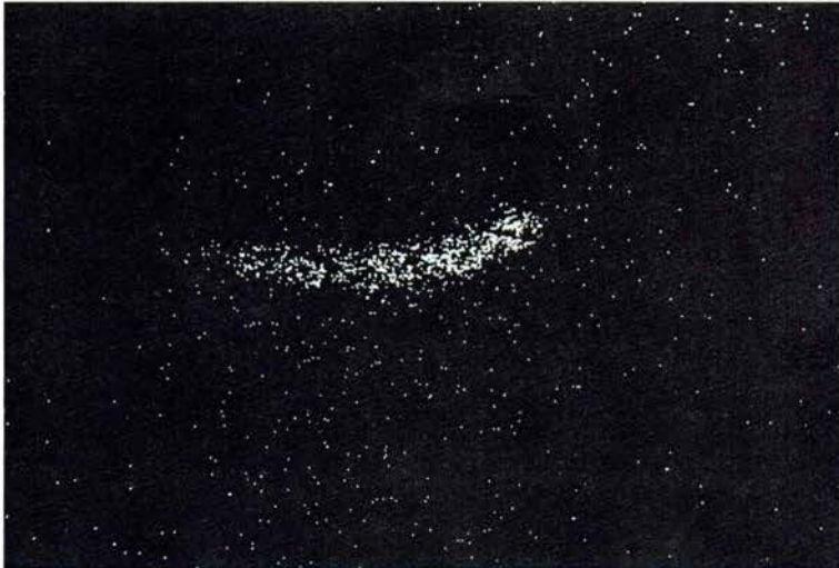
Fig. 10. - Mapping de la línia K\alpha del Si de la mateixa superfície de la figura 7 ( K\alpha = 1,74 \text{ KeV} ). Fig. 10. - Mapping of the line K\alpha of Si in the same surface as Figure 7 ( K\alpha = 1,74 \text{ KeV} ).
