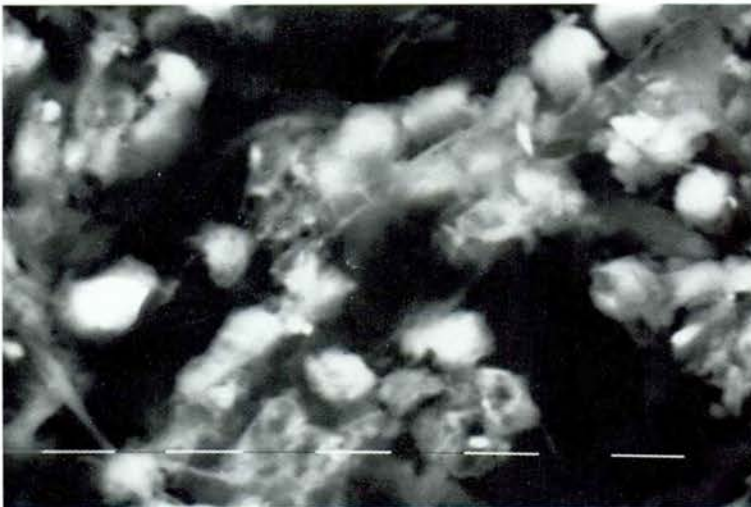
Fig. 10. - Zona de partícules analitzades individualment (Taula 1): Imatge per electrons secundaris. Marques de 10 \mu\text{m} (x 1.597).
