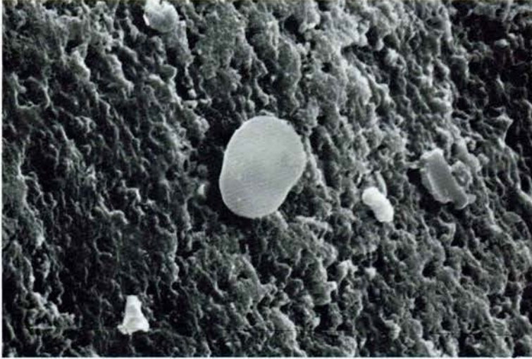
Fig. 23. - Microsfèrula de vaterita envoltada de carbonat càlcic a la superfície d'un càlcul tractat amb AUDC. Marques: 10 \mu\text{m} (x 2.500).
