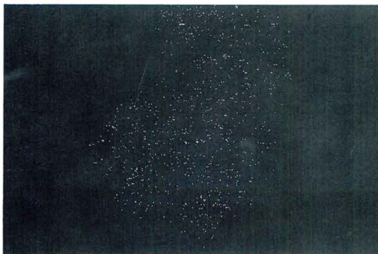
Fig 4. - Anàlisi «mapping» a 200 x, de la línia K \alpha (3,69 KeV) del calci, a la totalitat de la preparació mostrada a la figura 1.
