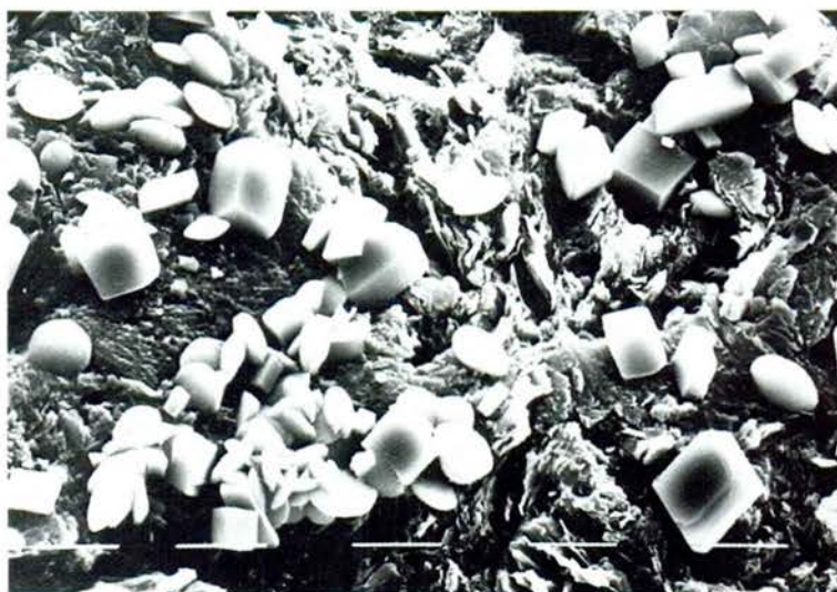
Fig. 14 b. - Cristalls aïllats amb resposta al Ca solament, no obstant haver-hi al fons petites partícules, d'aproximadament 0,1 \mu\text{m} , que donen resposta al Ca i al P. (x 1.250). Marques: 10 \mu\text{m} .
