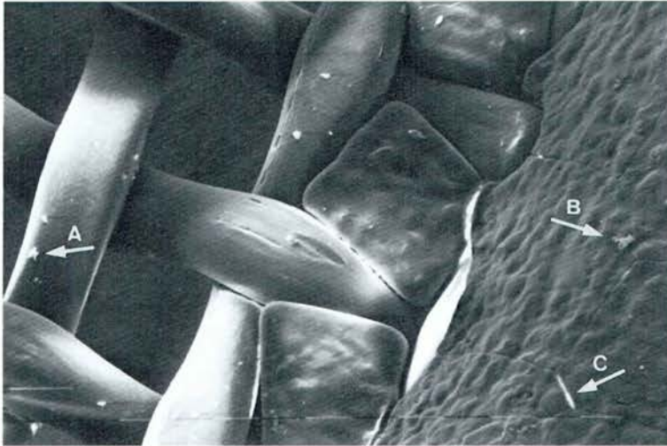
Fig. 7. - Imatge SEM per electrons secundaris. A la part esquerra hom pot apreciar l'entramat de fibres químiques que formen el filtre de la cambra d'aire; hom hi pot observar, també, irregularitats en llurs diàmetres, esquerdes superficials i impureses adherides (A, riques en titani). A la part dreta, apareix la paret de la càpsula dins la cambra d'aire, damunt la qual també hom hi pot observar conglomerats arrodonits rics en Ti (B) i allargassats rics en Si (C). Marques: 100 \mu\text{m} (x 460).
