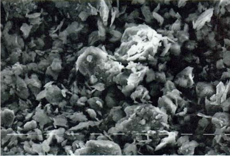
Fig. 9. - Cristalls de quars presents en talc comercial. Hom pot apreciar la presència majoritària de talc. Marques: 10 \mu\text{m} (x 640).
