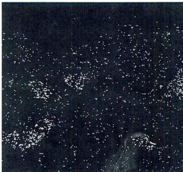
Fig. 5 b. - Mapping de fotons de Ca correspondent a la mateixa zona de la fig. 5 a.
