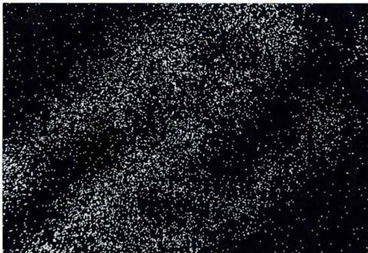
Fig. 7. - Mapping de Ca de la fibra vegetal de la figura anterior.
