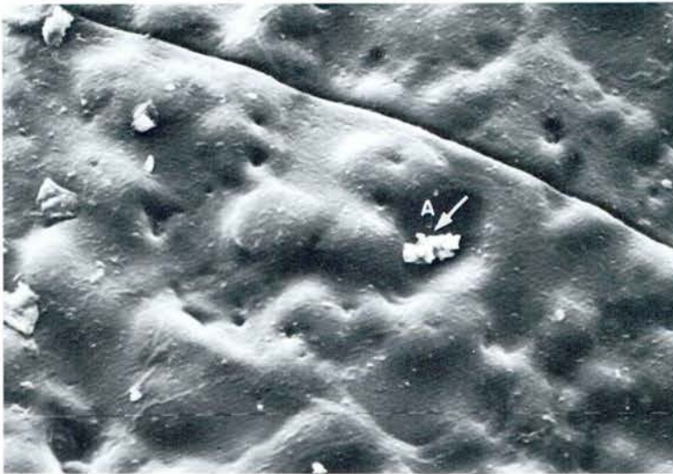
Fig. 6. - Imatge SEM per electrons secundaris de la superfície de la base de la càpsula dins la cambra d'aire. La fletxa indica impureses que donaren resposta EDX de Ti intensa. Recobrint amb or. Marques: 10 \mu\text{m} (x 320).
