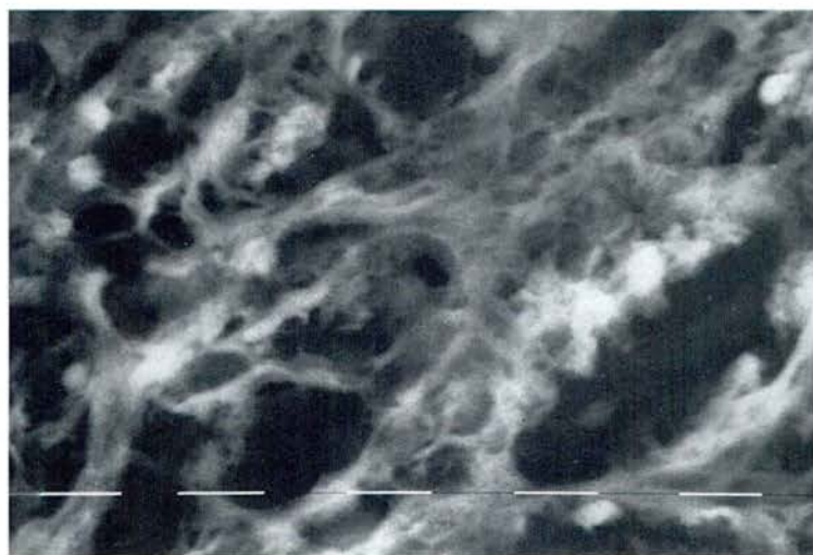
Fig. 12. - Zona de la mostra que presenta nòduls. Imatge d'electrons retrodispersats. Marques de 10 \mu\text{m} (x 1.853).
