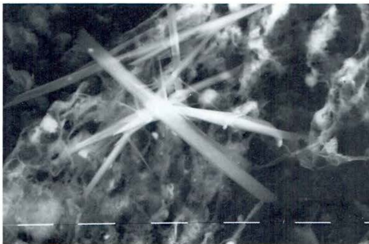
Fig. 2. - Detall de les fibres d'asbest de la figura 1. Hom pot apreciar-hi també nombroses microfibrils. Marques de 10 \mu\text{m} (x 1.611).
