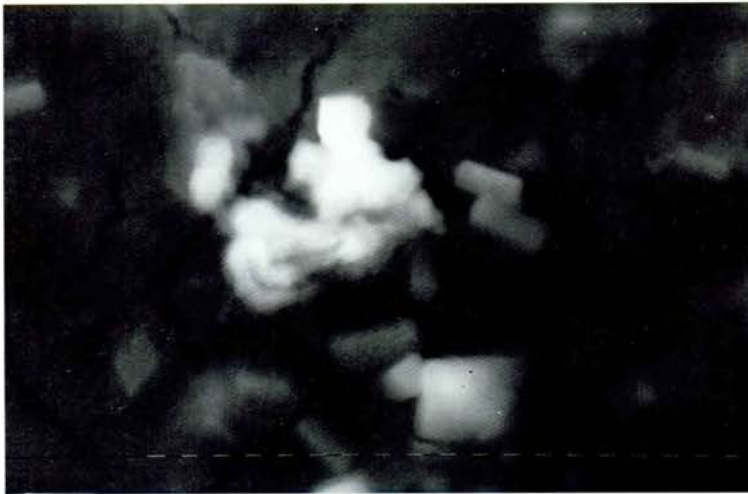
Fig. 5 i. - Es tracta de cristalls ja aïllats de la matèria orgànica. Hom els pot veure en dues formes, esfèrica i polièdrica. (x 2.500). Marques: 1 \mu m.
