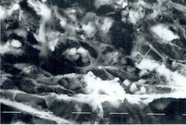
Fig. 15. - Zona de nòduls analitzats d'una manera individual (Taula 3). Imatge obtinguda mitjançant electrons secundaris. Marques de 10 \mu\text{m} (x 1.597).
