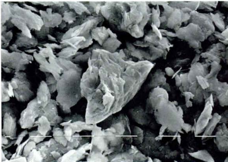
Fig. 10. - Cristalls de quars presents dins talc mèdic. Hom pot observar diverses partícules de talc damunt la seva superfície. Marques: 10 \mu\text{m} (x 1.250).
