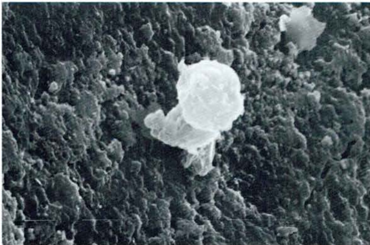
Fig. 22. - Microsfèrules de vaterita envoltades d'altres formes polimòrfiques de carbonat càlcic. Marques: 10\ \mu\text{m} ( \times 2.500 ).
