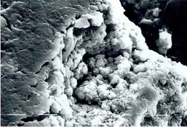
Fig. 5 f. - La mateixa zona de la fig. anterior, a 1.250 augments. Hom hi visualitza esfèrules d'apatita. Marques: 10 \mu\text{m} .
