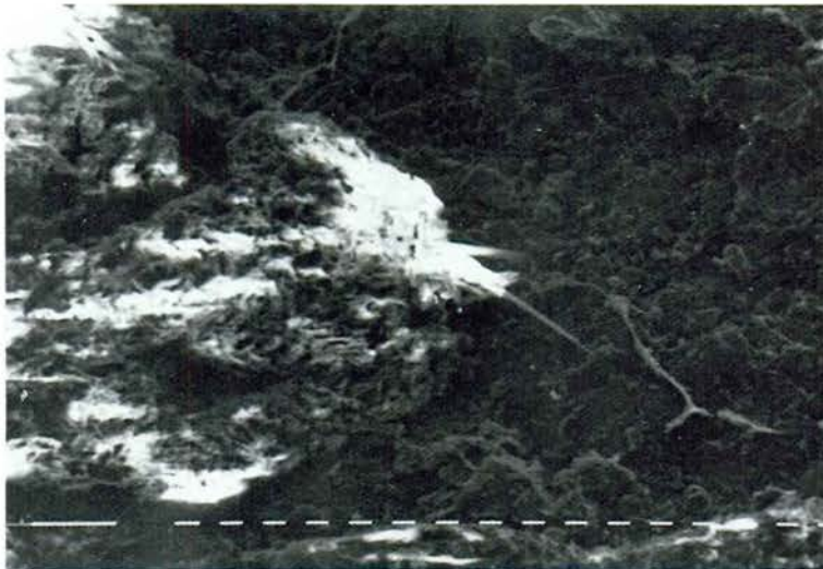
Fig. 4. - Conglomerat càlcic que envolta l'extrem d'una fibra d'asbest. Marques de 10 \mu\text{m} (x 409).
