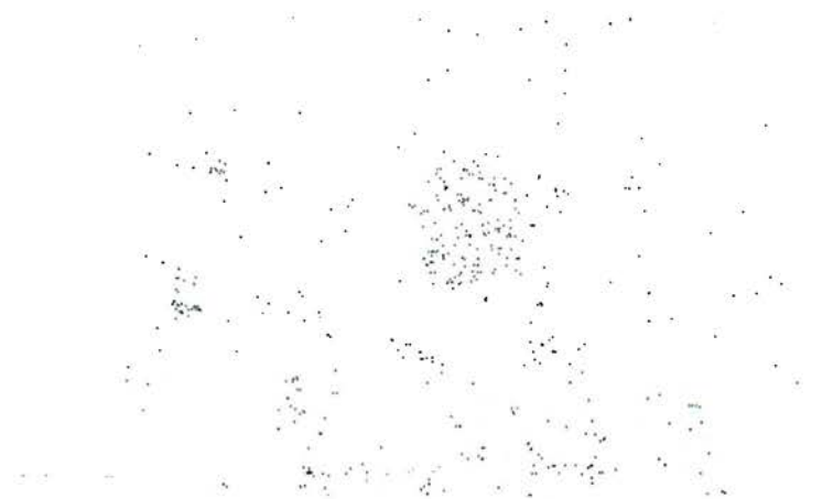
Fig. 3 c. - Mapping de fotons característics del P. Correspon a la mateixa zona que 3 a.
